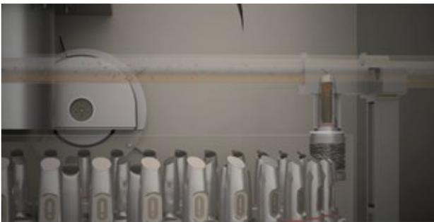
Fig.7. Remplissage d'une cuve du carousel.
