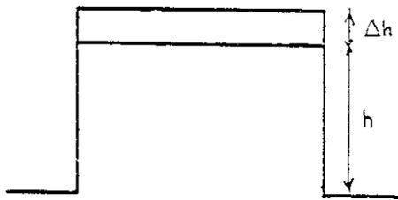
Considérons une montagne idéalisée. Quand elle se déforme (sous l'effet d'un glissement de terrain par exemple), elle descend d'une hauteur  $\Delta h$ .
