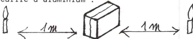
Les deux bougies étant à un mètre du photomètre, même éclairement des deux côtés.
