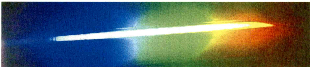
Fig.5 : spectre solaire obtenu avec un appareil numérique simple Kodak DC 200 ; on remarque le doublet du calcium dans le bleu
