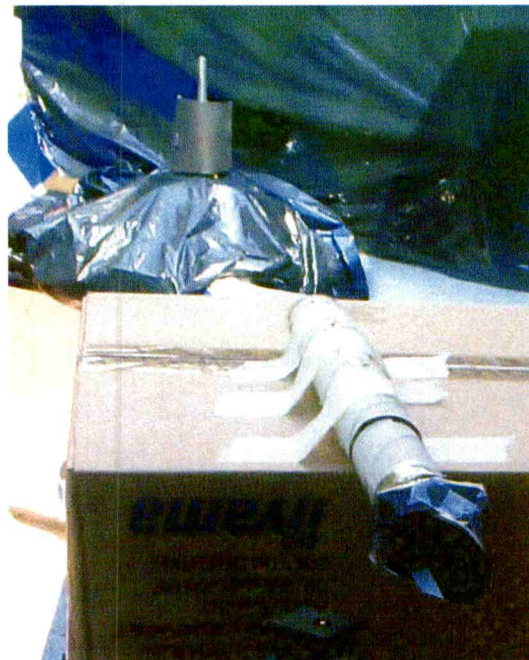
Fig.3 : au premier plan, tube de carton avec réseau, orienté vers la source lumineuse
