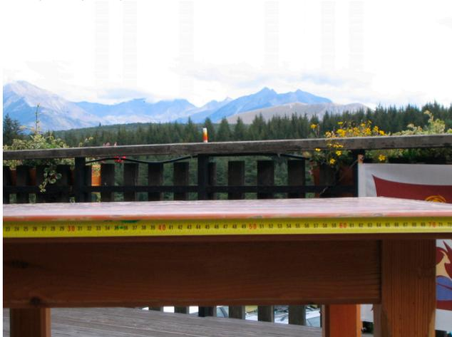
*Photo de l'objet dont on cherche la distance (tube de colle posé sur la barrière). Le ruban de calibration est fixé à un mètre de l'appareil photo..*
