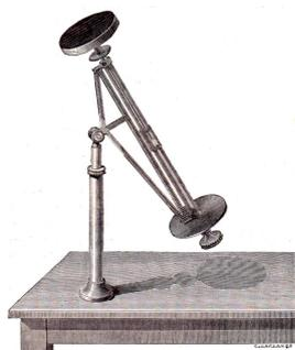
Fig. 1. — Pyrhéliomètre de Pouillet.
