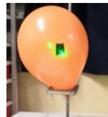
Fig.6. (à droite). En quelques secondes, le ballon explose sous l'effet de l'absorption de l'énergie lumineuse du laser.
