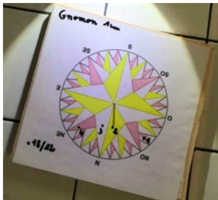
Fig.7. Illustration d'un « gnomon ». Il consiste ici en un pic à brochette de 1 cm planté verticalement dans une plaque en polystyrène. Ce gnomon projette une ombre de laquelle nous pourrions tirer de nombreuses informations.
