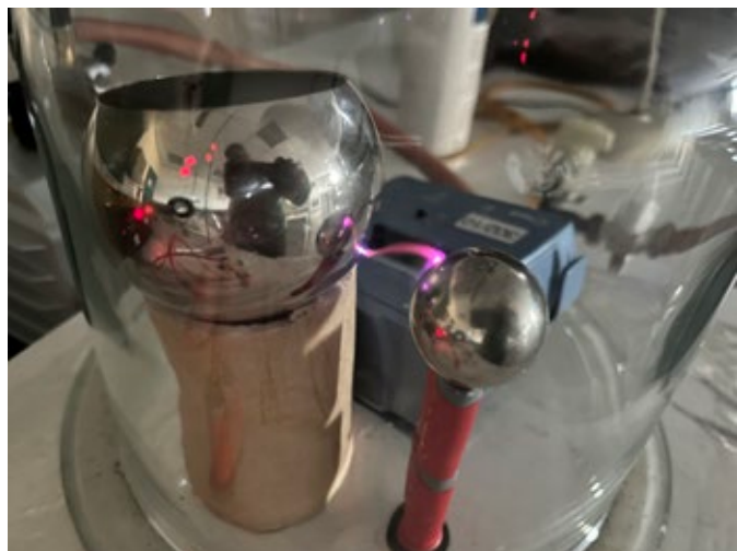
Fig.1. Un plasma s'établit entre les deux électrodes. La désexcitation des ions N_2^+ produit la lumière rose. Crédit A Durieux.
