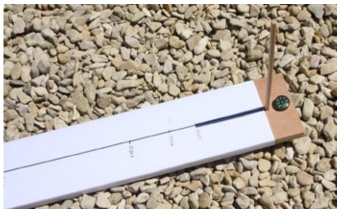
Fig.9. Méridienne horizontale constituée d'une planchette et d'un gnomon. Elle doit être orientée nord sud. On peut y noter la position de l'extrémité de l'ombre toutes les semaines ou tous les mois aux alentours du midi solaire (voir encadré), il suffit qu'il fasse beau. En réalité, il n'est pas nécessaire d'être très précis sur l'heure du midi solaire, la hauteur du Soleil varie peu au milieu de la journée.
