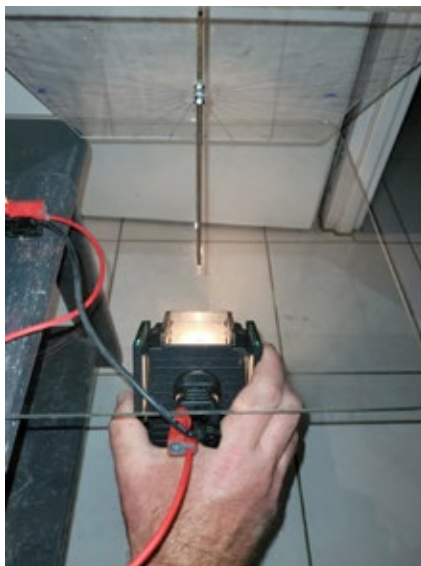
Fig.3. Le dispositif utilisé pour simuler différentes projections selon la déclinaison gnomonique du support.
