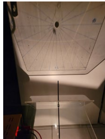
Fig.3. Le dispositif utilisé pour simuler différentes projections selon la déclinaison gnomonique du support.
